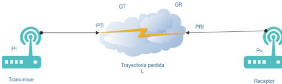
Figura 15 elementos de un sistema de comunicaciones inalámbrico
