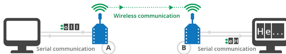
Figura 13 Comunicación entre dispositivos Xbee
