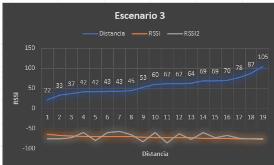
Figura 52 Comportamiento RSSI y el Modelo matemático con respecto a la distancia del escenario tres
