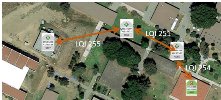
Figura 35 Red formada por cuatro nodos ya a una distancia de 149 metros
